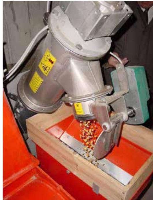
Feuchtmais-Entnahme zur Vermahlung durch luftdichte Klappe
