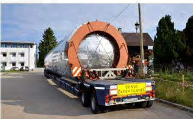
Der Puffer wird angeliefert. Länge: 20m, Durchmesser 3,50m; Leergewicht: 15.400kg
